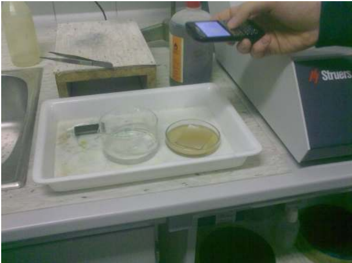
Slika 4. Izvođenje vježbe „Baummanov otisak“
