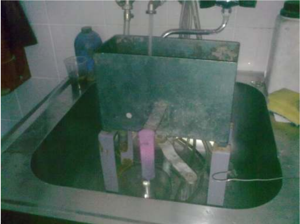
Slika 3. : Vježba izvođenja Jominyovog postupka
