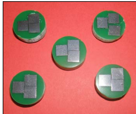
Slika 3.10. Uzorci nodularnog lijeva za metalografsku analizu nakon pripreme i nagrizanja
