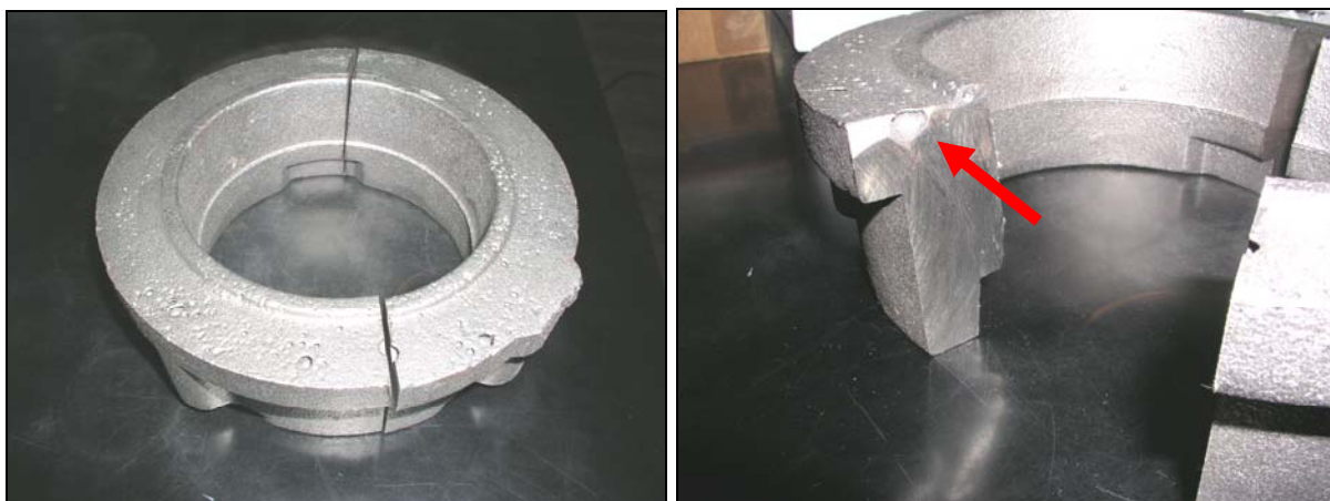
Slika 5.1. Plinski mjehuri na odljevku od nodularnog lijeva
