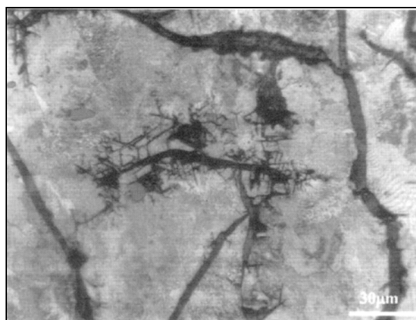
Slika 10.14. Widmanstättenski grafit u mikrostrukтури sivog lijeva. Odljevak s debljinom stjenke 100 mm. Sadržaj olova 0,0042%, nagrizen o nitalom
