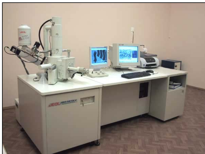
Slika 3.14. Pretražni elektronski mikroskop (SEM) s energetske disperzivnim spektr. (EDS)
