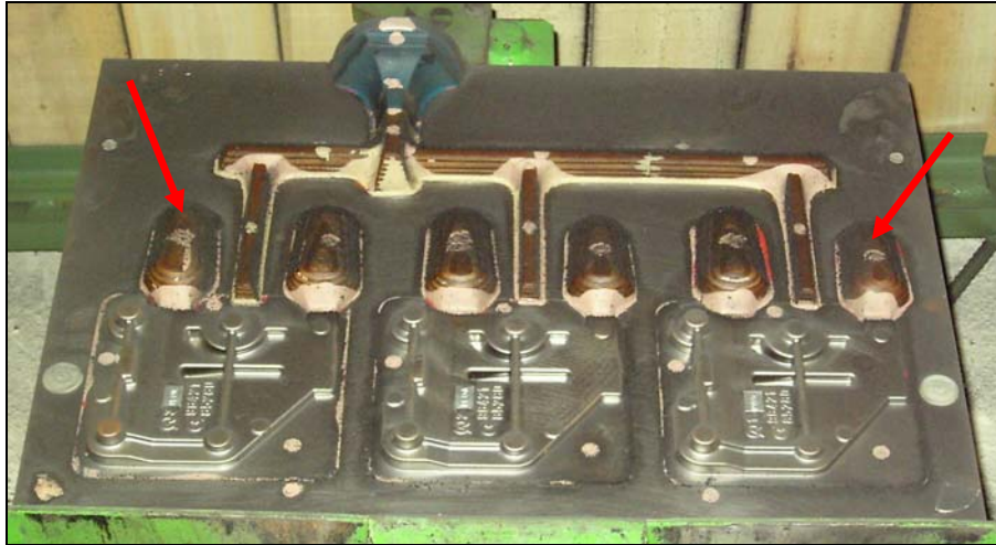
Slika 6.40. Modelna ploča (pojila u obliku valjka)
