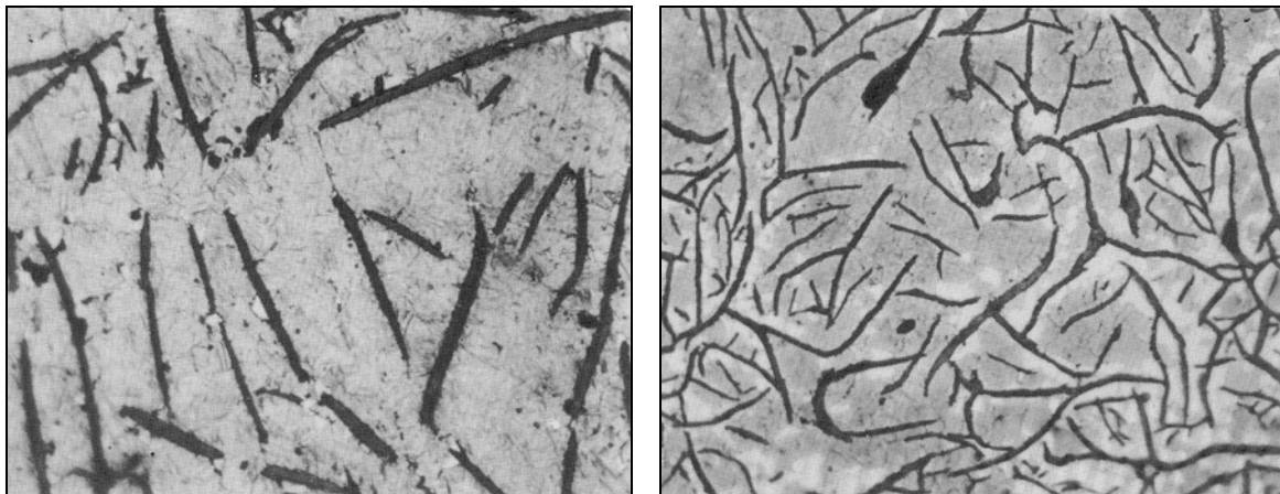
Slika 2.20. Eutektoidno područje ravnotežnog faznog dijagrama Fe-C- 2,0 %
