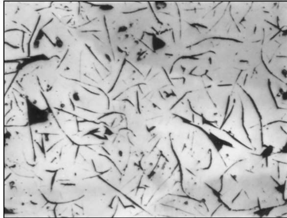
Slika 2.56. Metalografska snimka mikrostrukture silicijskog lijeva (0,84 %C, 13,84 %Si)
