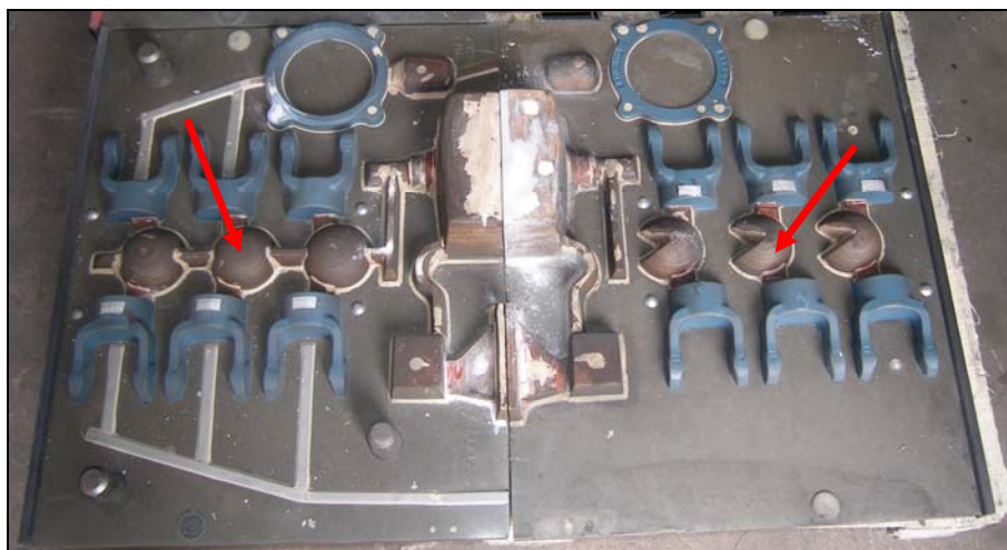
Slika 6.42. Modelne ploče (strelicama su označena standardizirana pojila u obliku kugle)
