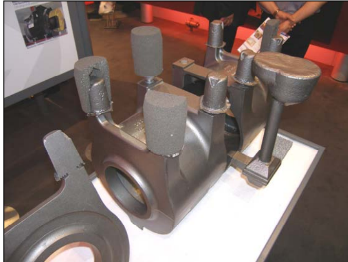
Slika 5.36. Primjer egzotermnih košuljica
