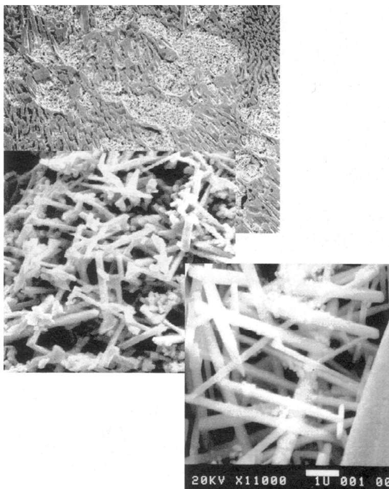
Slika 8.43. Snimka morfologije sekundarnih M_7C_3 karbida u visokokromnom željeznom lijevu načinjena pretražnim elektronskim mikroskopom (SEM)
