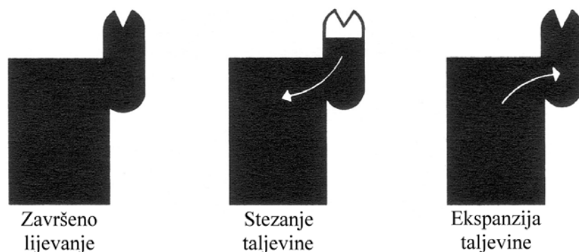
Slika 5.21. Princip metode napajanja kontrolom tlaka
