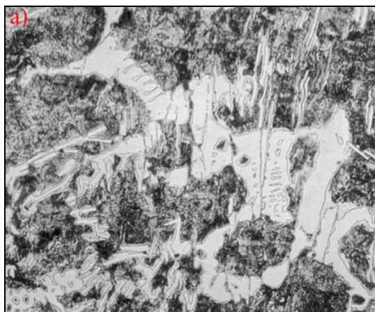
Slika 7.1. Metalografska snimka mikrostrukture polazne bijele strukture (eutektički karbidi + perlit), nagrizeno stanjem nital, 400x
