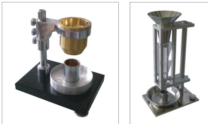
Slika 3.22. Hall-ov i Scott-ov uređaj za mjerenje viskoznosti i nasipne gustoće [39,40]
