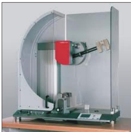
Slika 7.3. Ispitivanje žilavosti metodom po Charpy-ju [77,78]
