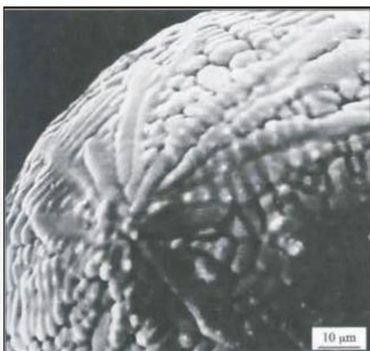
Slika 3.3. Struktura čestice praha superlegure na bazi nikla (SEM) [2]
