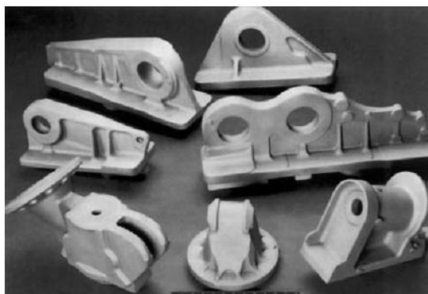
Slika 5.18. Vruće izostatski prešani odljevci [3]
