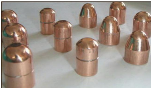
Slika 6.9. Kapice elektroda za točkasto zavarivanje [64]
