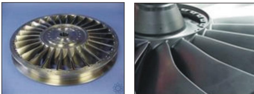
Slika 6.11. Dijelovi turbina od sinterirane legure titana [67]
