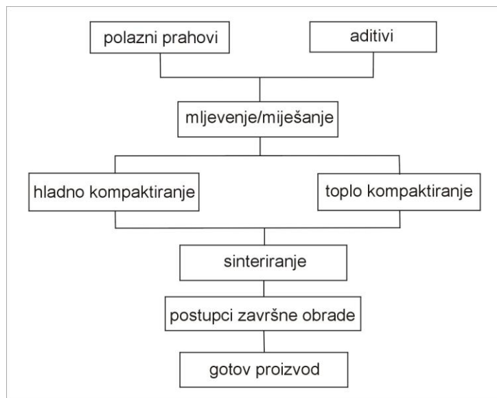
Slika 1.2. Hodogram tehnoloških operacija konvencionalnih postupaka metalurgije praha [8]
