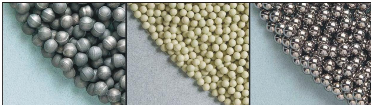
Slika 2.2. Kuglice za mljevenje izrađene od različitih materijala [9]
