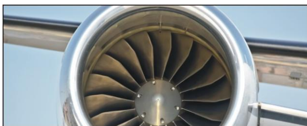
Slika 6.10. Motor zrakoplova izrađen od sinterirane superlegure [66]
