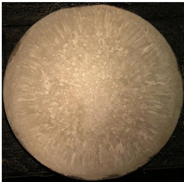
Slika 2.24. Strukturne zone na poprečnom presjeku kontinuirano lijevane čelične okruglice (nagrizanje amonijevim persulfatom) [16]
