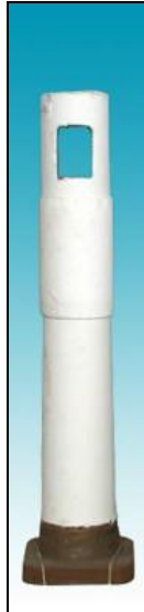
Slika 2.38. Uranjajući izljevnik za lijevanje slabova [43]
