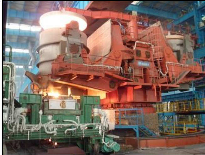
Slika 2.8. Zakretni toranj za brzu izmjenu lonaca [23]
