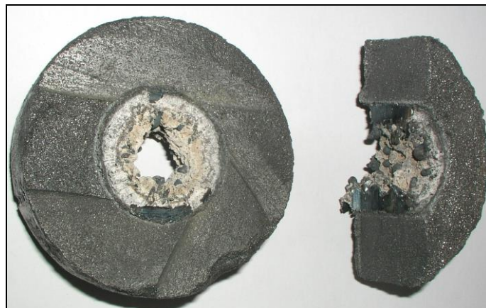
Slika 2.53. Nakupine \text{Al}_2\text{O}_3 čestica u uranjajućem izljevniku nastale tijekom lijevanja čeličnih okruglica
