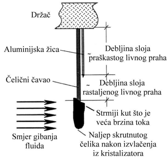
Slika 2.81. Jednostavan način mjerenja debljine sloja rastaljenog livnog praha na površini tekućeg čelika u kristalizatoru te smjera i brzine tekućeg čelika [40]
