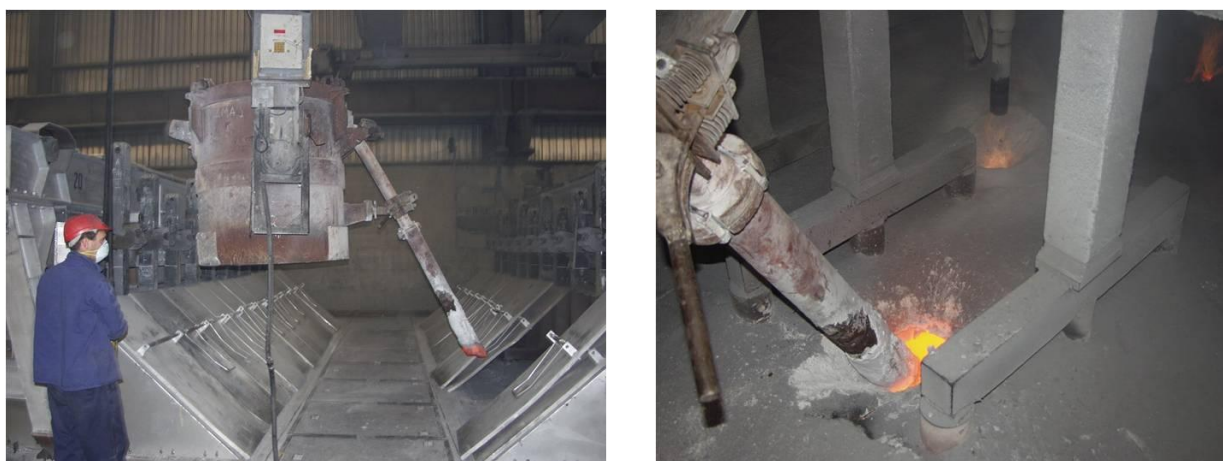
Slika 6-13. Vakuumski lonac za vađenje aluminija u tvornici „Aluminij d.d.“ Mostar a) vakuumski lonac b) vađenje aluminija
