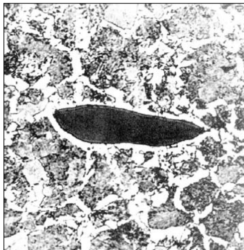
Slika 2.3.4. Sulfidni uključak ( \text{MnS} ) u čeliku sa 0,35 %C
