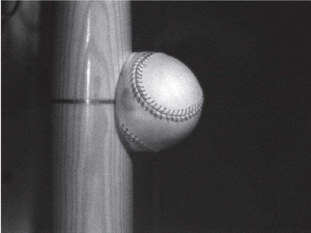
Slika 3.1: Snimka deformacije loptice tijekom sraza s batom (izvor: UMass Lowell Baseball Research Center).
