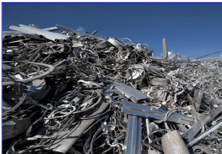
Slika 39. Očišćeni čelični otpad nakon čišćenja kiselinom 90 (bez metalnih prevlaka, boja, lakova, korozijskih produkata i sl.)
