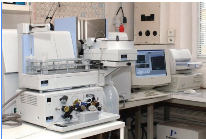
Slika 59. Spektrometar atomske apsorpcije opremljen sustavima za tehniku plamena i tehniku atomizacije uzorka u grafitnoj kivetu 173
