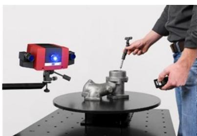
U praksi je čest slučaj da ne postoji dokumentacija za pojedine kalupe, alate ili odljevke koji se godinama uspješno proizvode. Problem nastaje kada se alat ili kalup potroši te ima za posljedicu da proizvođač više nije u mogućnosti isporučiti dimenzionalno ispravan proizvod. Najbrži način da se ponovo uspostavi proizvodni proces je upravo digitalna rekonstrukcija geometrije postojećih uzoraka dokazanim postupcima povratnog inženjerstva.
